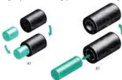
Рисунок 1 Деталь как сумма или разность геометрических тел
